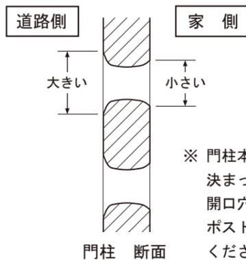
※ 門柱本体には、ポスト取付面が決まっています。開口穴周囲の凹みの大きい側をポスト取付面として、設置してください。
