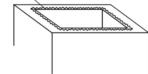
カラーシリコンコーキング剤を使用しますと、塗布量過多塗布位置によっては笠木と本体の隙間からコーキング剤がはみ出し、外観を損ねる可能性があります。
